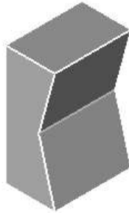
Formschräge mit einem oberem Winkel von + 15 Grad und einem unterem Winkel + 15 Grad
