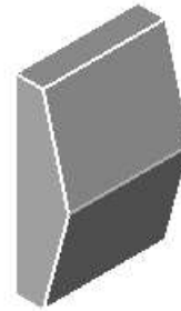
Formschräge mit einem oberem Winkel von - 15 Grad und einem unterem Winkel -15 Grad
